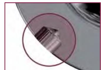
➔ Équilibrage par enlèvement de matière par perçage. Exemples de calculs et croquis détaillés à la page suivante.
