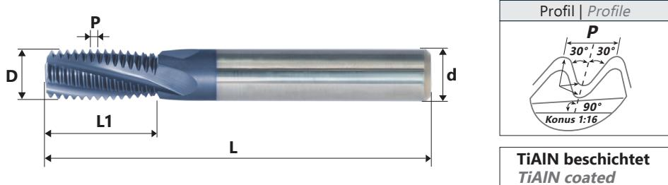
gleiches Werkzeug für Innen- und Außengewinde
