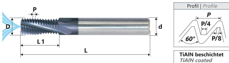
mit Innenkühlung – Werkzeuge zur Herstellung von Innengewinden
