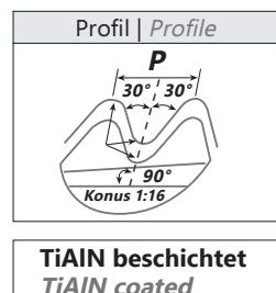
mit Innenkühlung - gleiches Werkzeug für Innen- und Außengewinde
