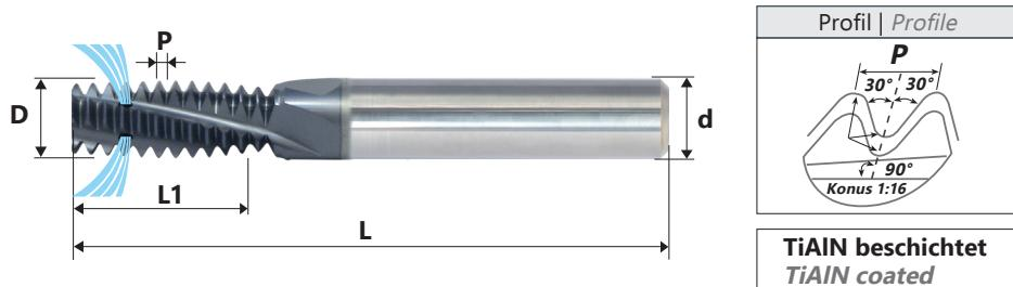
Innere Kühlmittelzufuhr mit Nutenaustritt - gleiches Werkzeug für Innen- und Außengewinde
