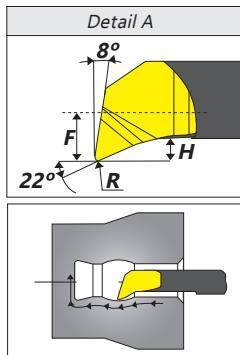
Profildrehen und Bohren | Profiling and Boring
