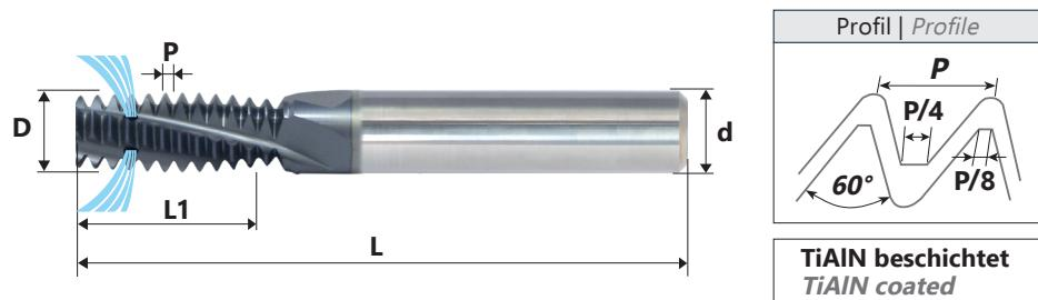
innere Kühlmittelzufuhr mit Nutenaustritt - Werkzeuge zur Herstellung von Innengewinden
