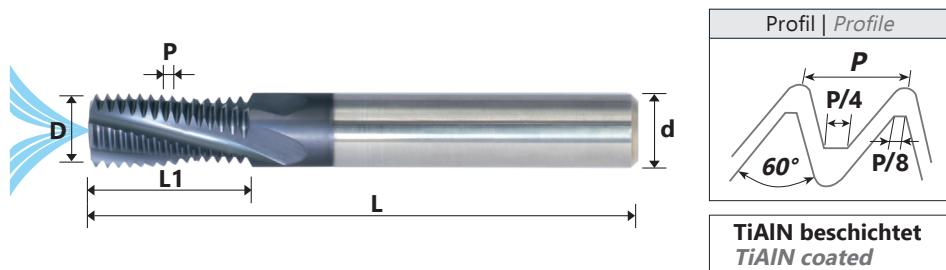
mit Innenkühlung - Werkzeuge zur Herstellung von Innengewinden
