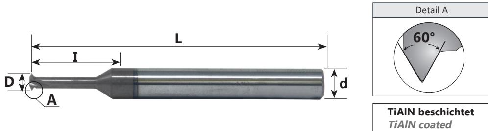
Werkzeuge zur Herstellung von Innengewinden | tools for internal thread
