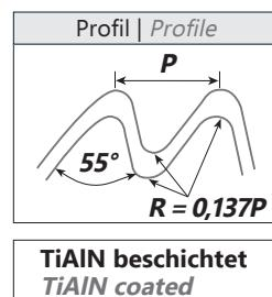
BSF, BSP - gleiches Werkzeug für Innen- und Außengewinde
