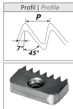
gleiche Platte für Innen- und Außengewinde | same insert for external and internal thread
