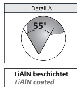
gleiches Werkzeug für Innen- und Außengewinde | same tool for internal and external thread
