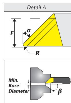
45° Senken und Profildrehen mit Innenkühlung | Chamfering and Profiling with internal coolant
