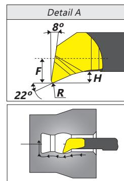
Profildrehen und Bohren | Profiling and Boring
