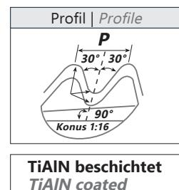
gleiches Werkzeug für Innen- und Außengewinde
