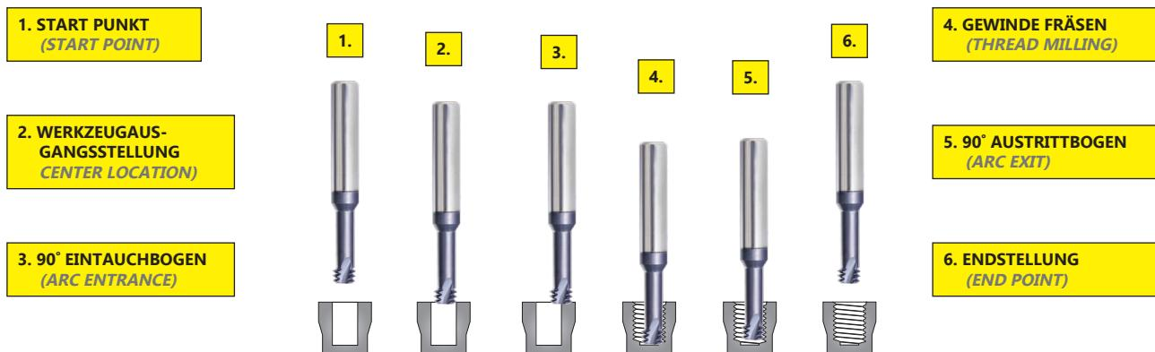
Vergleichstabelle Mini-Fräser - Gewindefräser | *Mini Thread mills vs. Taps*
