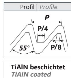
BSF, BSP mit Innenkühlung – gleiches Werkzeug für Innen- und Außengewinde
