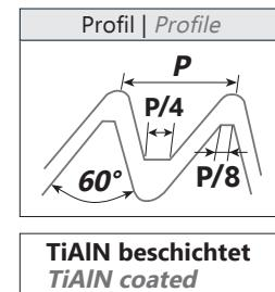
Werkzeuge zur Herstellung von Innengewinden | tools for internal threads
