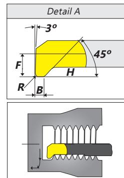
Gewindefreistich, Anfasen und Einstechen | Thread Relief, Chamfering and Grooving
