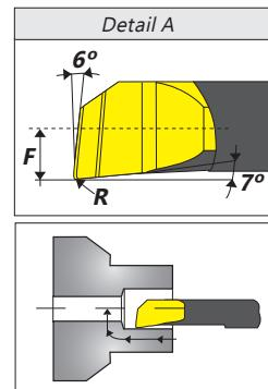
Innendrehen mit Innenkühlung | Boring bars with coolant channel
