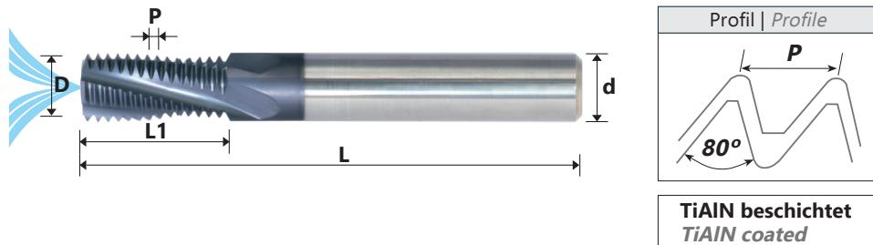
mit Innenkühlung - gleiches Werkzeug für Innen- und Außengewinde
