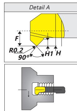
Anfasen und Bohren | Chamfering and Boring
