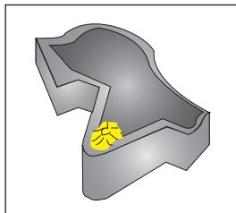
1. Schnittgeschwindigkeit erhöhen
