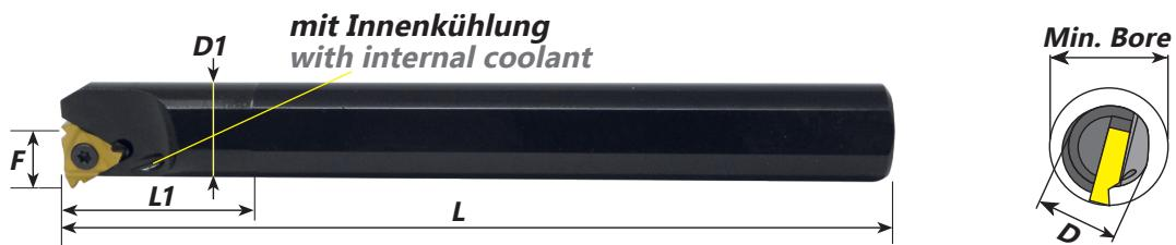
mit Innenkühlung | with internal coolant
