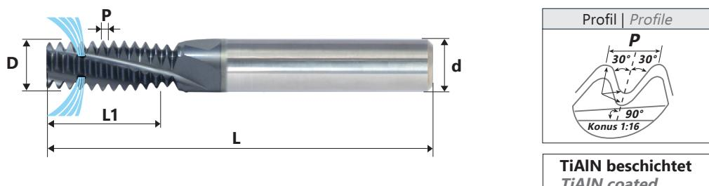
innere Kühlmittelzufuhr mit Nutenaustritt - gleiches Werkzeug für Innen- und Außengewinde
